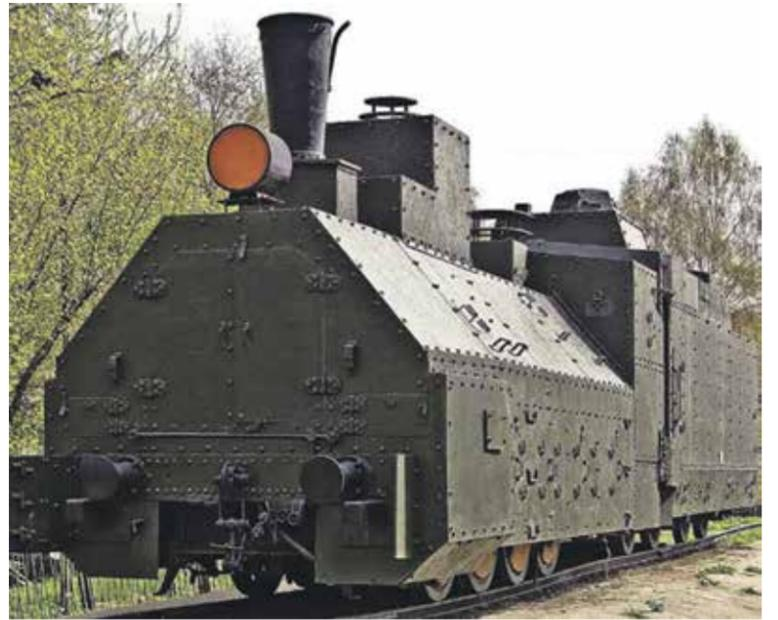
Паровоз серии «Ов», одетый в броню. Такими же были бронепаровозы Ов №5520 и Ов №5983 бронепоездов «Лунинец» и «Железнодорожник Алтая»
